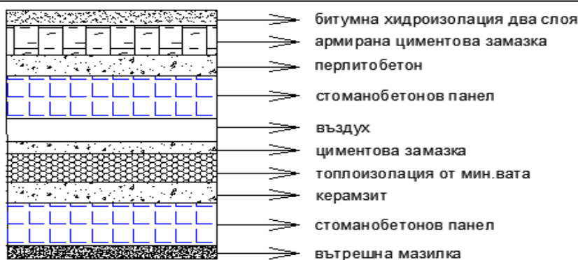
Фиг. 77. Покрив – тип 1 след ЕСМ
