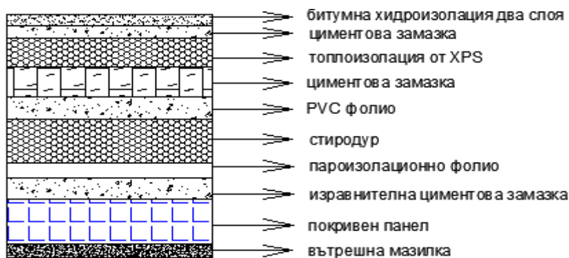
Фиг. 78. Покрив – тип 2 след ЕСМ
